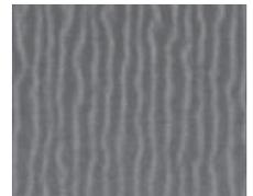
※1：欠陥とまでは見なされない程度のゆず肌（塗装表面の粗さ（ラウンド））のうち、比較的きついもの。
